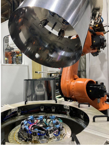
Abb. 1: Nachhaltigkeit: Besprühung mit Bio- Schmiermittel vor der Umformung
