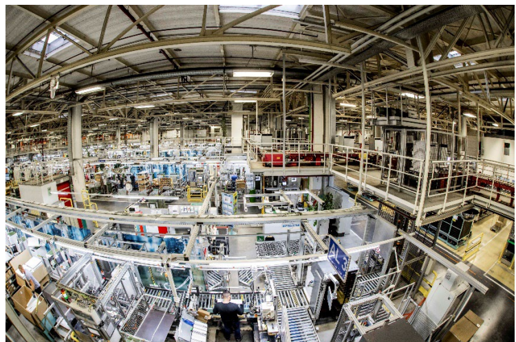
Abb. 3: Fertigung der Geschirrspüler an den Endmontagelinien
