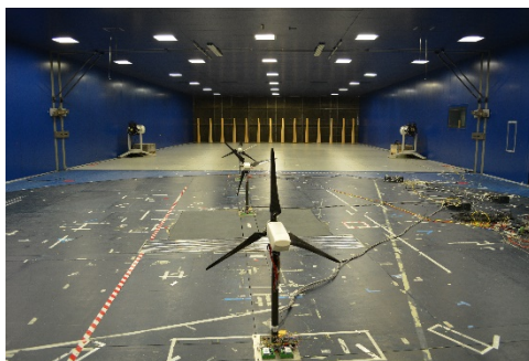
Abb. 2: Drei TUM-Modellwindkraftanlagen (Durchmesser 1m) im Windkanal des Politecnico di Milano. Links und rechts kann man zwei LiDAR-Geräte zur Windmessung sehen, welche von Dänemarks Technische Universität zur Verfügung gestellt wurden. Bildquelle: Lehrstuhl für Windenergie, TUM
